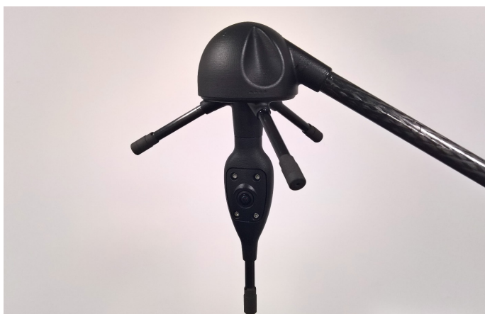
Vue du capteur « méduse » développé par Bruitparif
